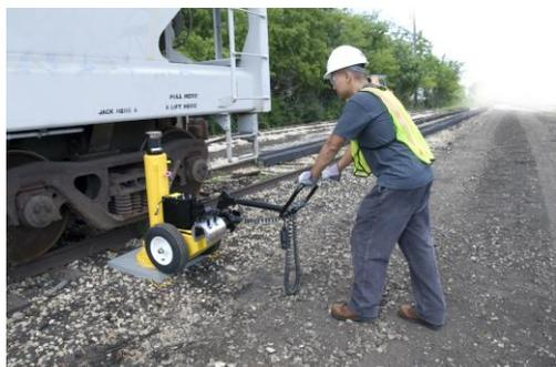
Высокопроизводительные мобильные домкраты часто называются подкатными домкратами. Наша линейка подкатных домкратов предназначена для использования на широком спектре оборудования OTR. Наша продукция поможет вам максимально эффективно и безопасно поднять самое тяжелое оборудование вашего автопарка.
